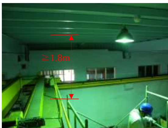
圖 2 於保養、檢修時，將架空式起重機駛至兩橫樑間加以固定，使屋頂與其走道間保持 1.8 公尺以上
