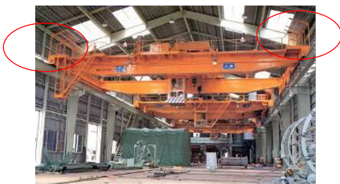
圖 3 走道兩側空間未滿 1.8 公尺處，設置高 1.5 公尺以上之頂蓬
