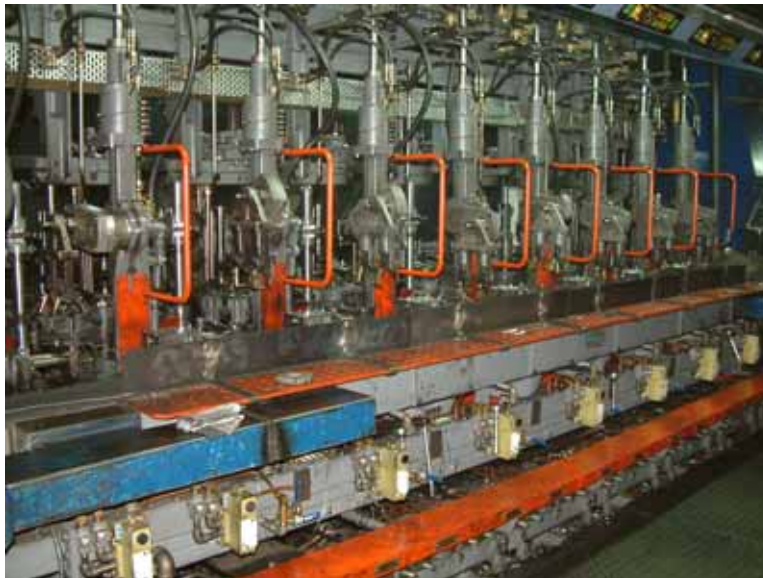
圖 7.8 玻璃瓶及玻璃容器的壓製
