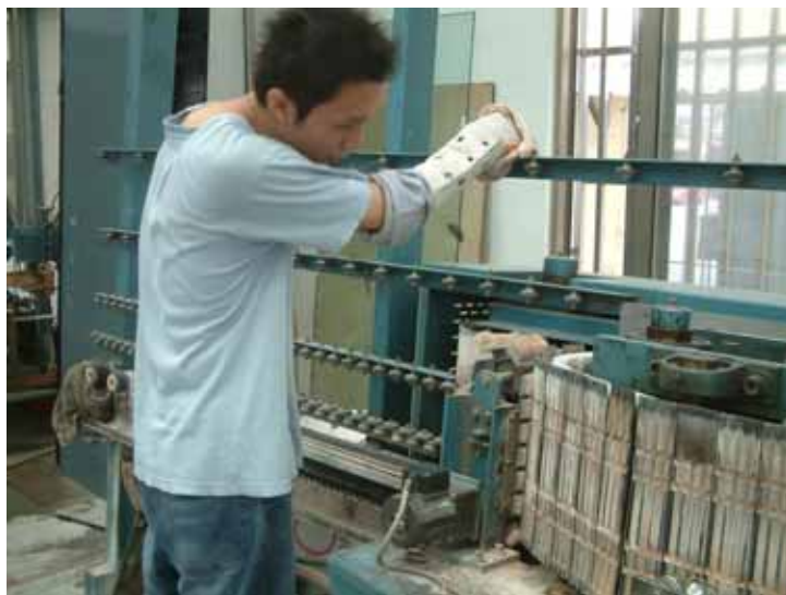
圖 7.13 作業人穿戴手套及特製的防護肘套
