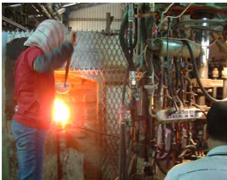
圖 7.4 將玻璃膏從坩鍋窯引出送至氣動沖床，壓製成為成品
