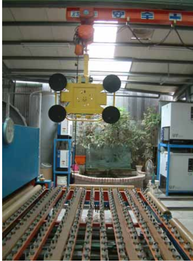
圖 7.12 空氣吸盤式起重吊掛搬運工具
