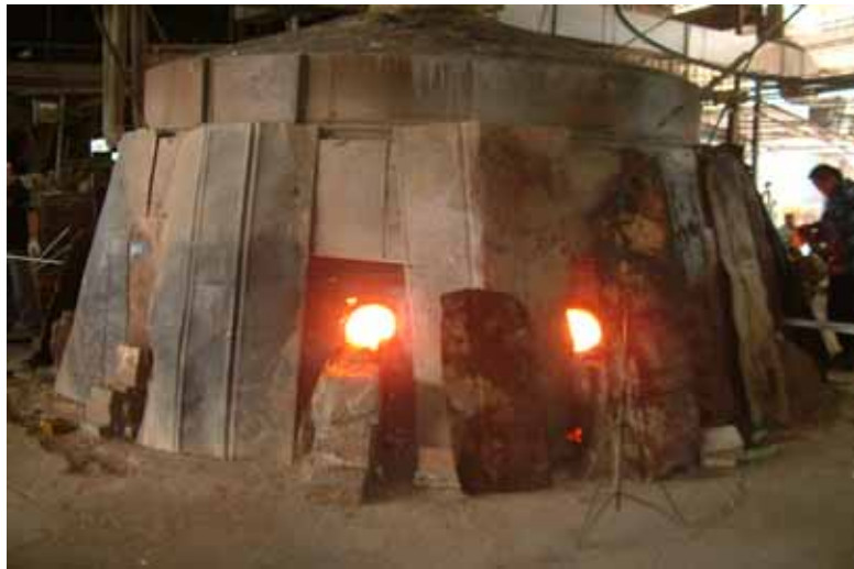
圖 7.3 下焰式八卦爐實際運作外觀圖
