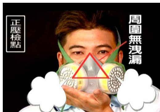
步驟二：慢慢吐一口氣，感覺空氣是否由面體周圍洩漏，若沒有，則表示通過正壓檢點。
