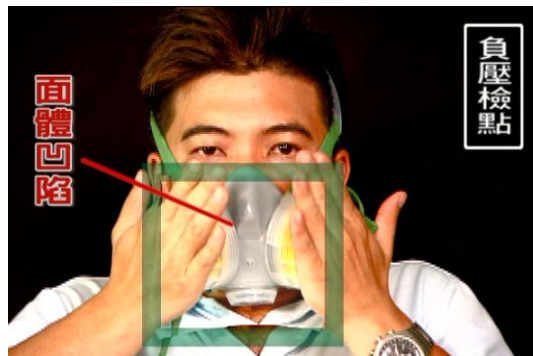
步驟二：用力吸一口氣，感覺面體是否有凹陷，若有，則通過負壓檢點。
