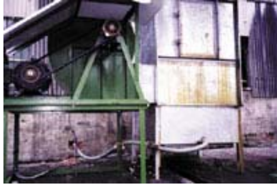
圖 3.14 將收集後之油霧廢氣、導入裝有過濾裝置之吸油設備處理
