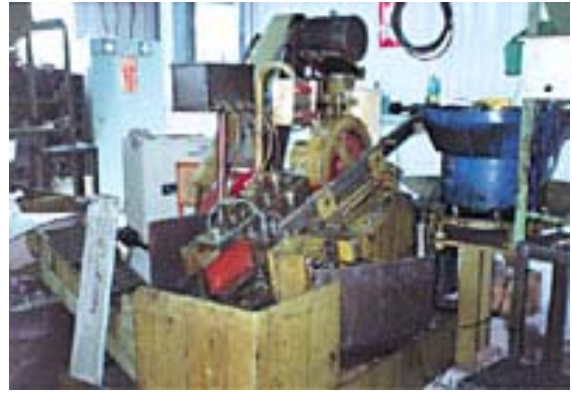
圖 3.8 螺絲軋牙機油霧污染源
