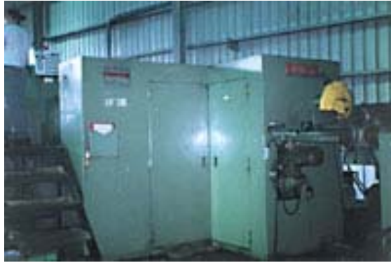
圖 3.11 打頭機裝置密閉氣罩
