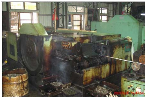
圖 3.10 螺絲打頭機油霧污染源
