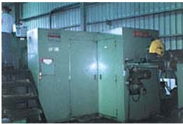
圖 3.9 螺帽成型機油霧污染源
