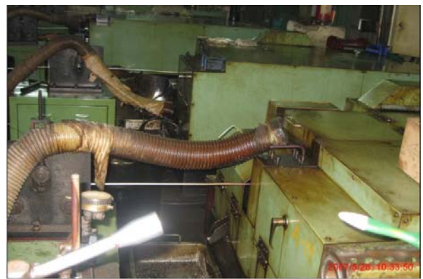
圖 3.10 螺絲打頭機油霧污染源
