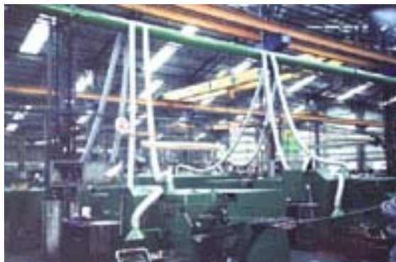
圖 3.15 利用設有可撓管之集氣罩以收集打頭時所產生之油霧
