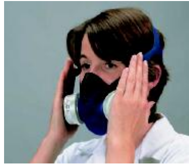
圖 16 防毒面罩負壓檢點（圖片來源：Drager 公司）
