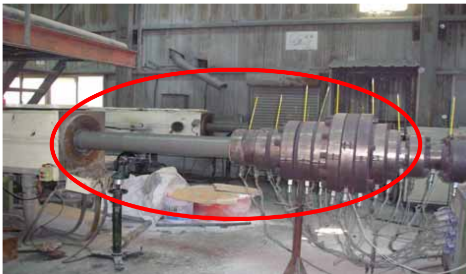
圖 4.6 擠壓機可能造成觸電、灼燙傷害
