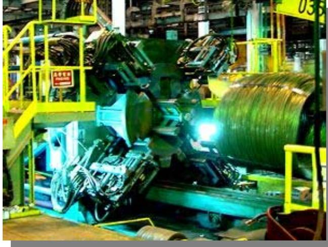
圖 8.9 使用網綁設備將盤元以鋼帶作包裝
