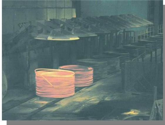
圖 8.1 經由盤捲機完成之盤元線材
