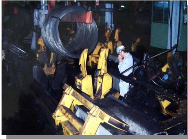
圖 8.8 盤元線材之精整軋延作業線
