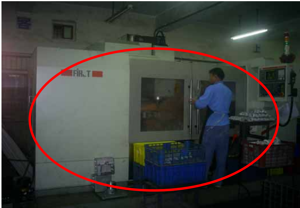
圖 3.6 產品噴砂塗裝時為防止粉塵危害，使用濕式密閉室
