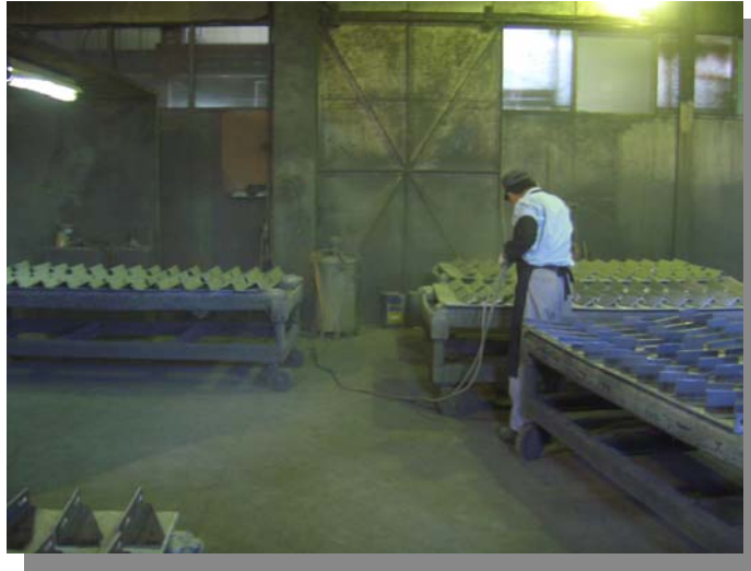
圖 2.5 零件製造過程中，由工作人員進行表面噴塗作業
