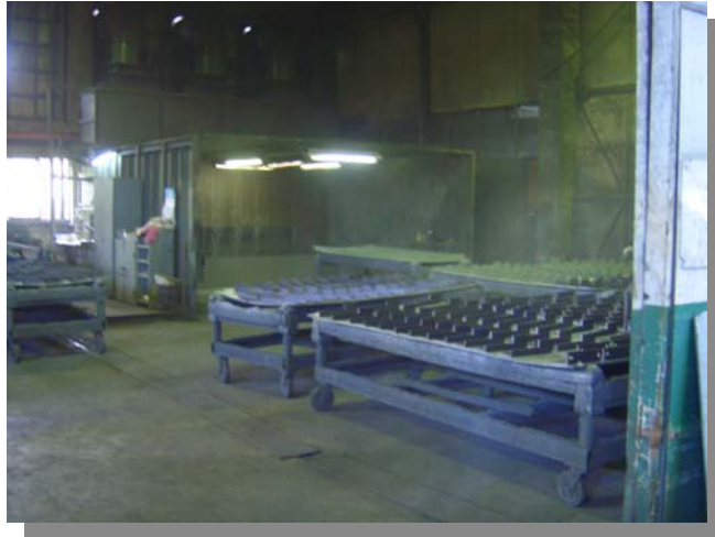
圖2.10 有機溶劑作業場所無通風排氣設施
