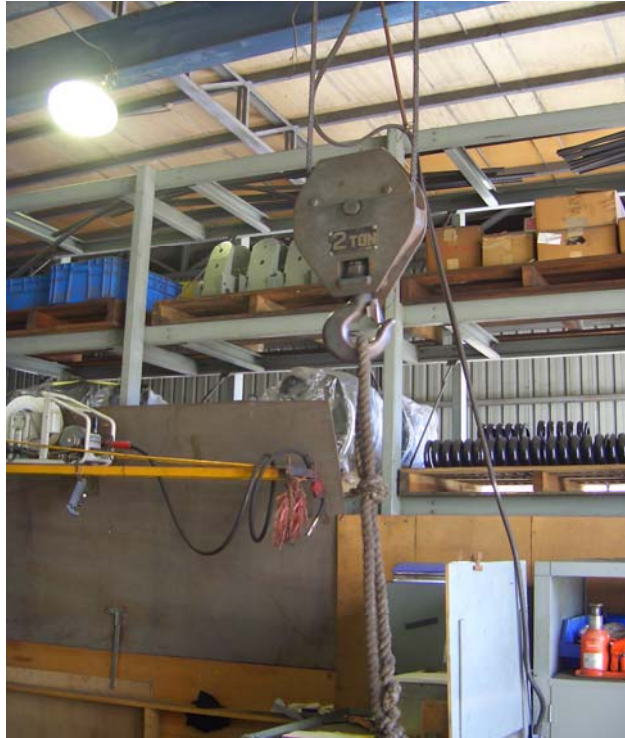
圖 2.11 吊鉤上之防滑舌片應維持正常可用之狀態
