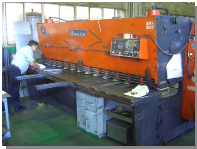
圖 2.6 工作人員依設計圖尺寸使用剪床裁切適當尺寸之工件
