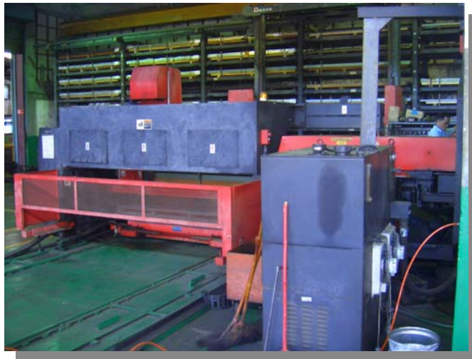
圖2.3 全自動衝孔機作業時衝模與工件撞擊所產生之聲響往往大於90分貝，為作業環境主要之噪音源
