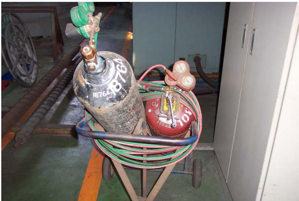
圖2.7 作業現場經常可見的氧氣及乙炔鋼瓶
