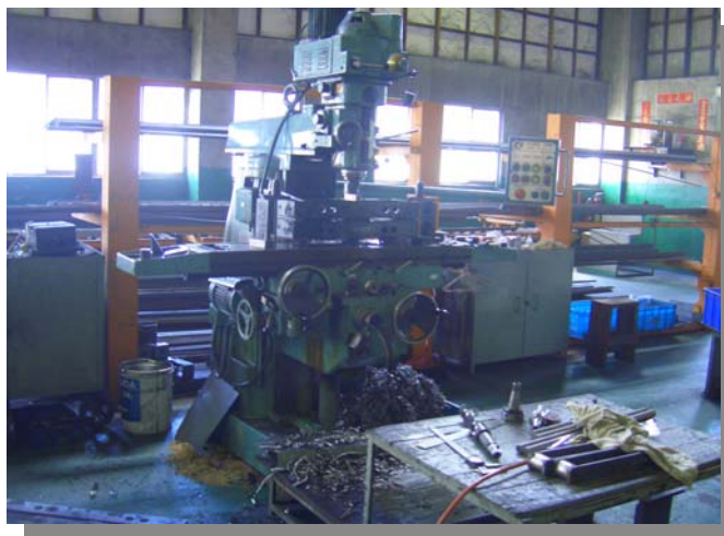
圖2.4 工作母機作業時切削所產生之鐵屑飛濺，及傳動機構旋轉部位若未加以防護，經常造成異物進入眼睛及捲入事故
