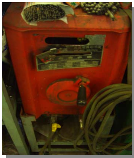
圖2.8 電焊機未加裝自動電擊防止裝置
