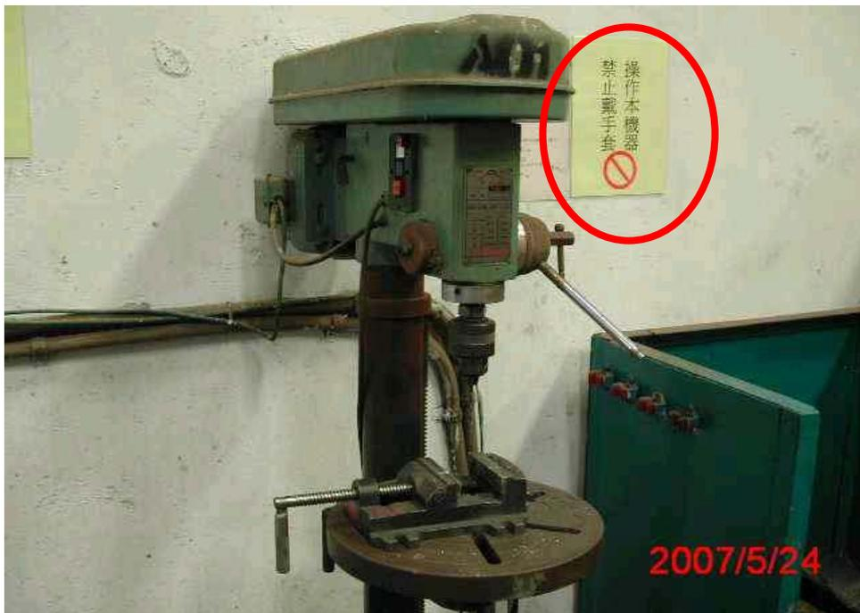
圖7.5 鑽孔機應標示「禁止戴手套」之字樣
