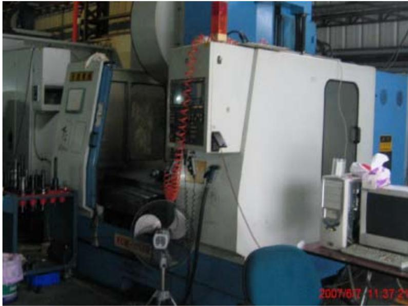
圖 7.4 各類 CNC 工具機應設置安全門連鎖系統
