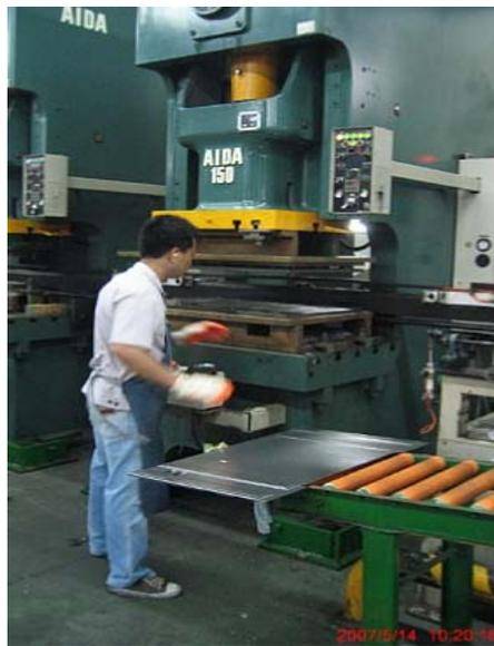
圖 7.8 衝壓作業如屬噪音作業場所作業人員應戴耳塞、耳罩
