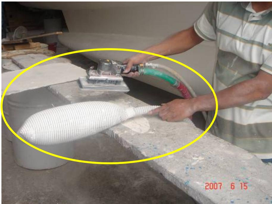
圖 6.13 自動吸塵震動砂光機
