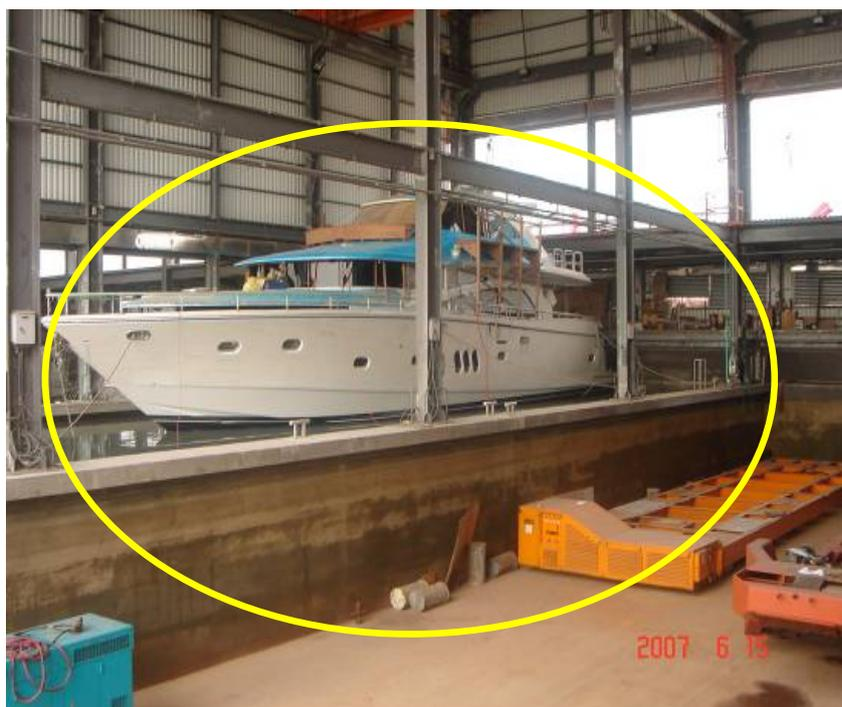
圖 6.6 遊艇成品試水艙內施工時未使用局部排氣設備
