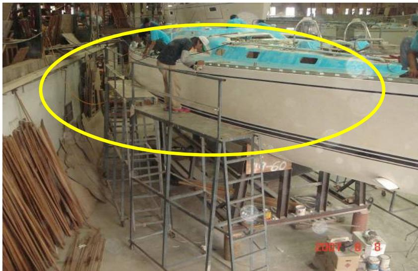
圖 6.5 高差 2 公尺工作台設護欄
