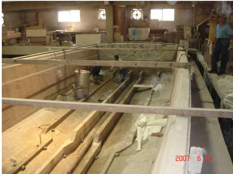
圖 6.8 船殼積層施工無排氣設施
