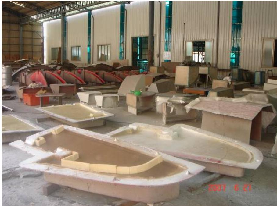
圖 6.10 零件成型模及積層成品
