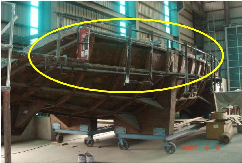
圖 6.3 船殼模架工作台設有護欄
