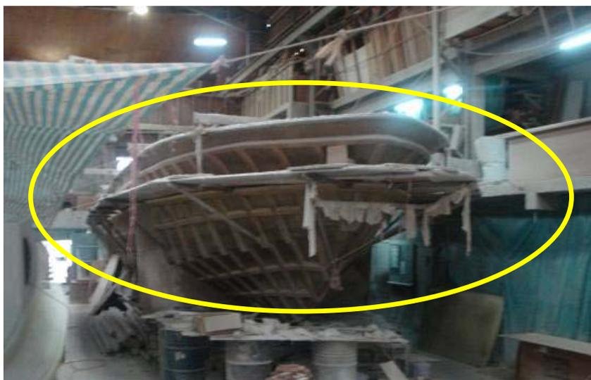
圖 6.2 船殼模架工作台未設護欄
