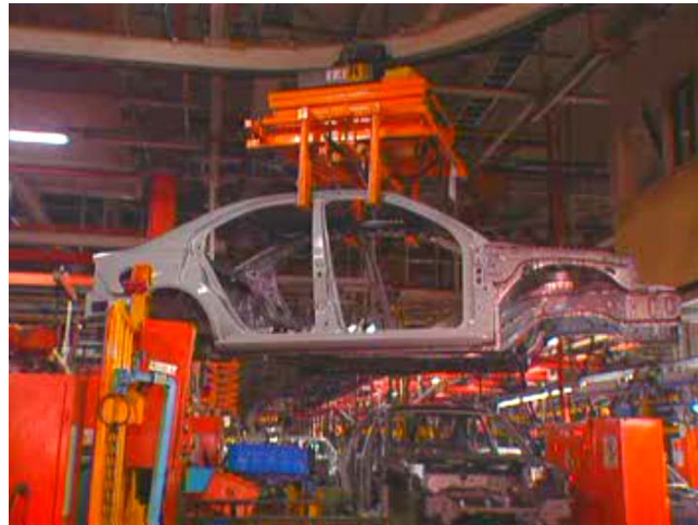
圖 5.14 應用精密的輸送系統將各部零組件精確地送至各個裝配點
