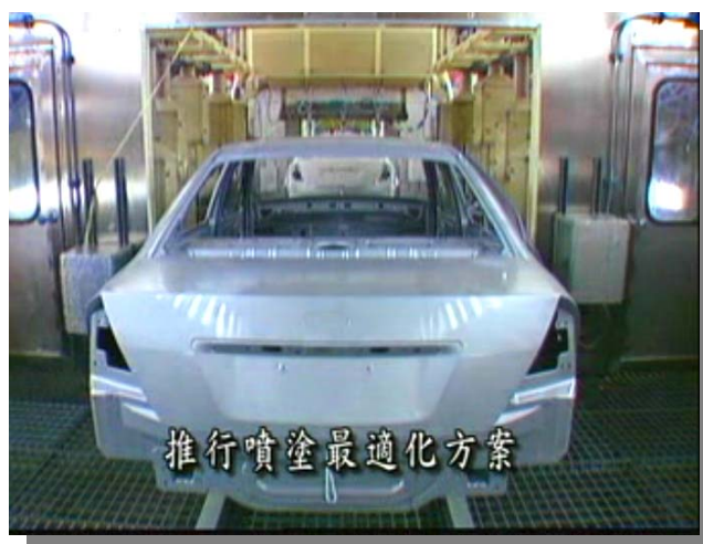
圖 5.10 噴塗完成送至大型烘爐中烘乾漆料，此處為高溫作業環境
