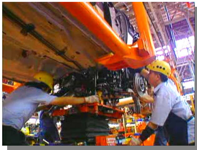
圖 5.11 車身底盤下方之零組件安裝，作業人員必需經常以高過頭部之肢體動作從事作業
