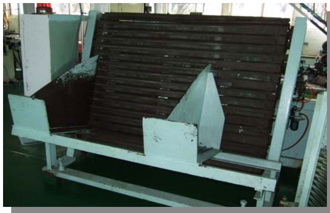
圖 5.3 管件落下時常造成管件相互撞擊而形成高噪音作業場所
