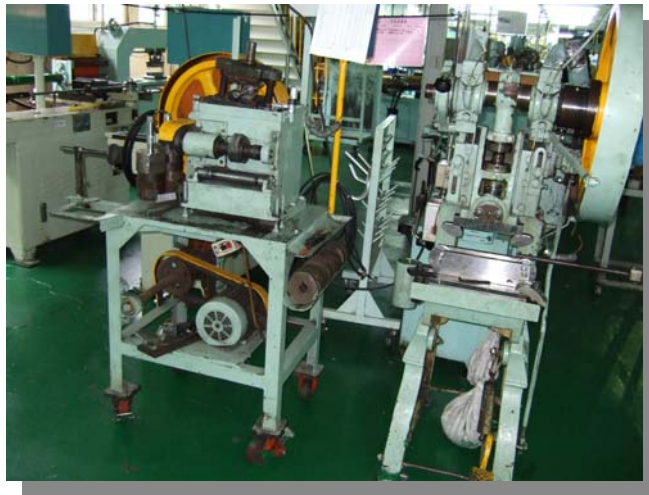
圖 5.2 衝壓設備執行切、彎管材之動作
