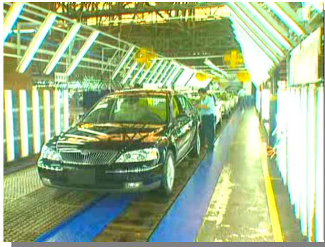
圖 5.13 完成組裝之車輛由專業資深人員作細部外觀目視檢驗
