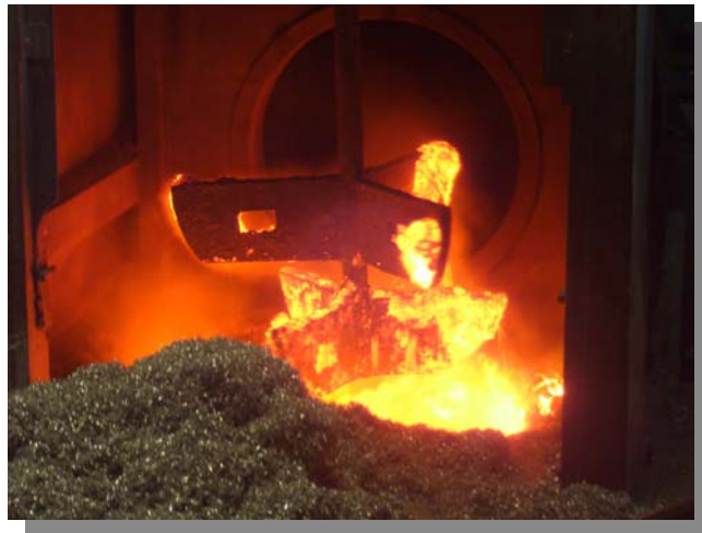
圖 5.5 冶煉作業現場除有高溫危害外，亦有害光線、金屬煙煙等危害
