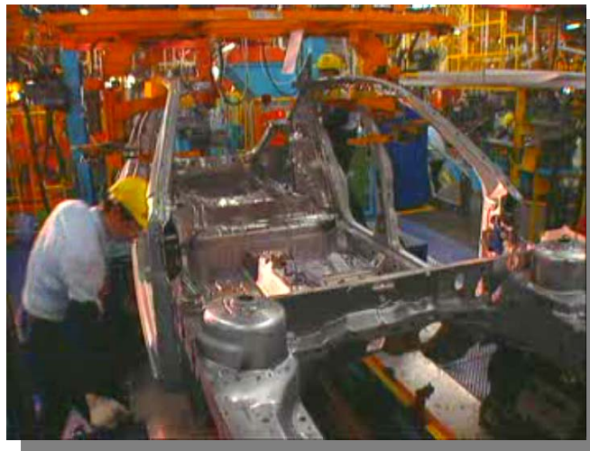
圖 5.7 作業人員拉著懸掛式焊接機進行各種角度之焊接
